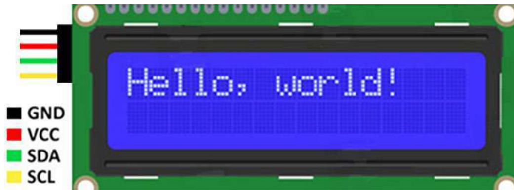
Рис. 1. Подключение модуля ЖКИ к Ардуино
